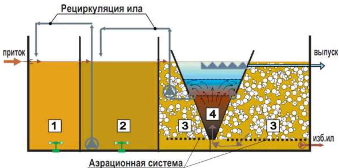
Рис. 1. Схема интегрированного биологического реактора 1 – анокисическая зона (дефосфотация); 2 – зона денитрификации; 3 – аэробная зона (нитрификация); 4 – сепарация (активный вторичный отстойник)
